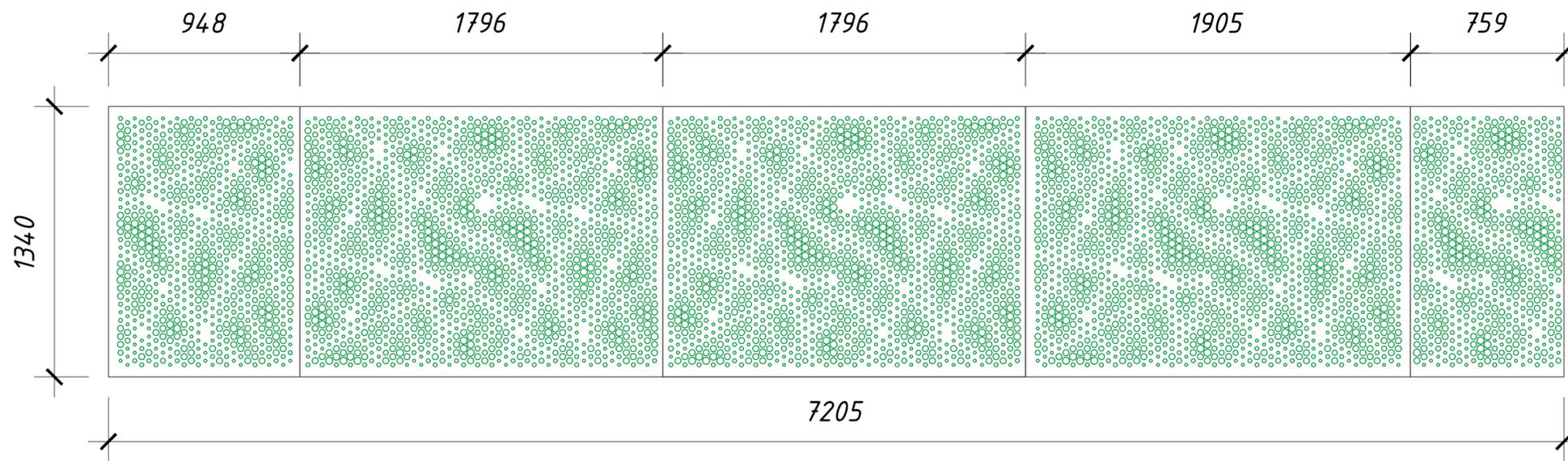
Развертка блещочного экрана ОГ-2 для корпуса 7.7.1 из алюминия t=2 мм. RAL 020 40 05
