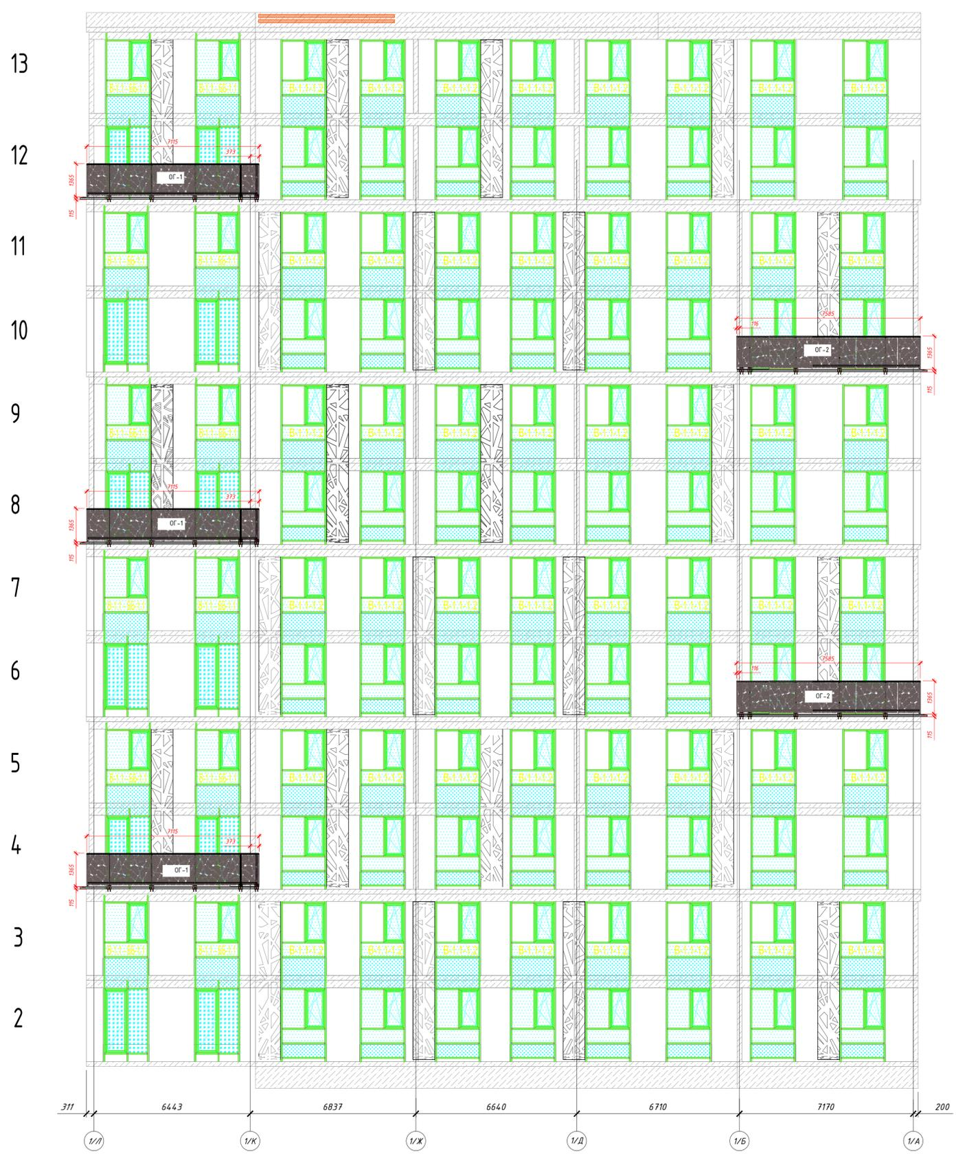
Спецификация ограждений балконов для корпуса 7.7.1
